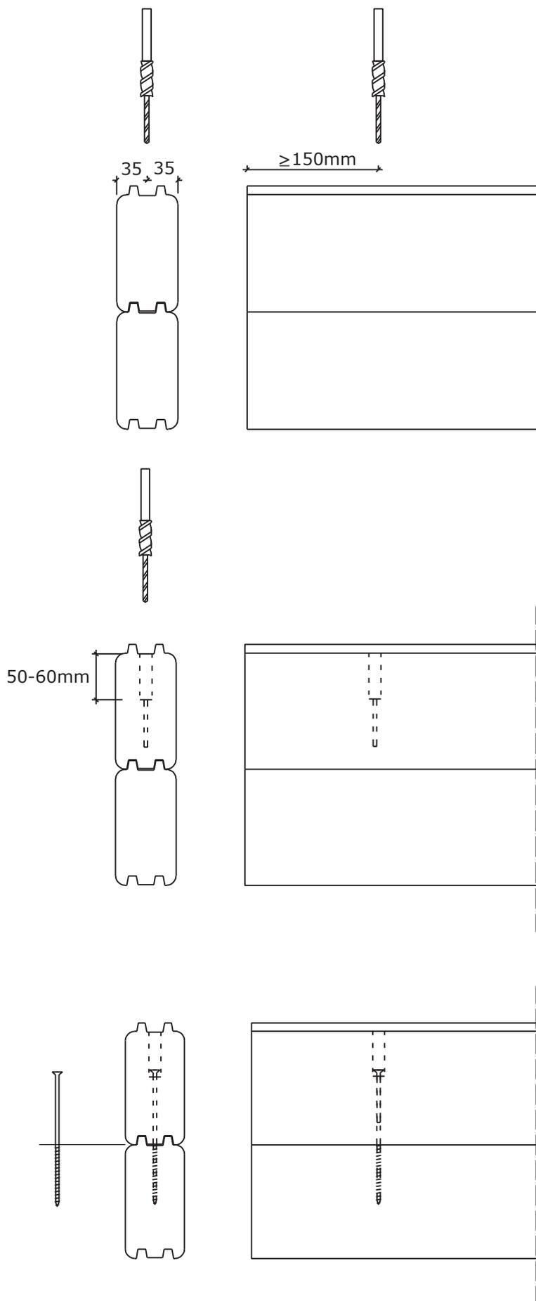
Skruvarna i väggschemat installeras enligt dessa instruktioner.
